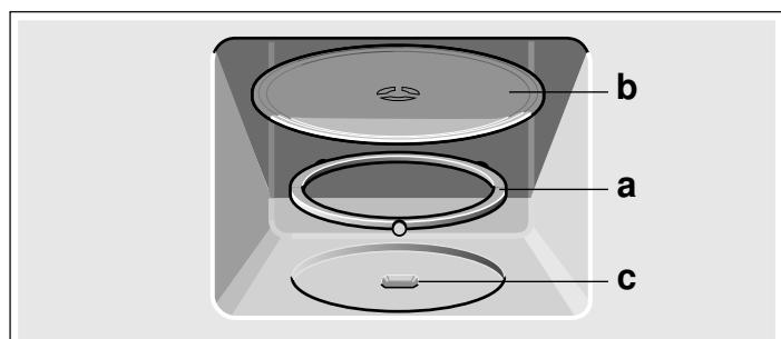
**Opomba:** Aparat uporabljajte le z vstavljenim vrtljivim krožnikom. Poskrbite, da bo pravilno nataknjen. Vrtljivi krožnik se lahko obrača v levo ali desno.
