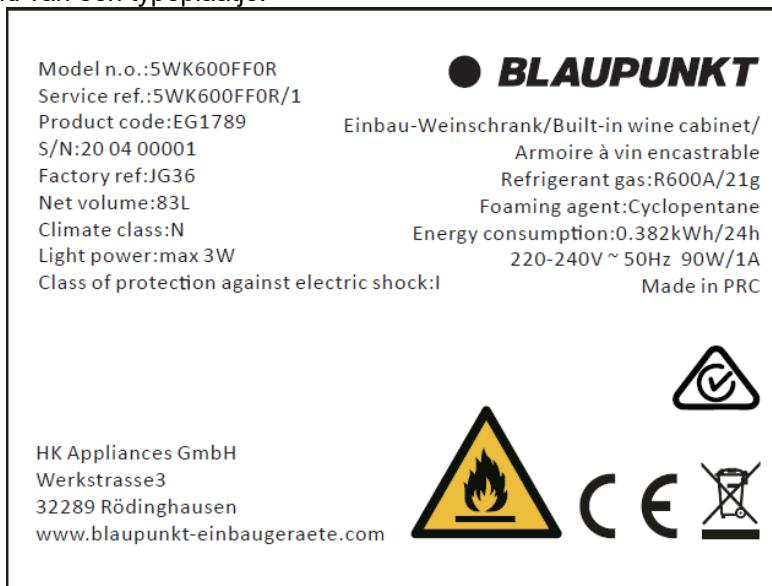
De op de binnen- of achterzijde van het apparaat (afhankelijk van het model) geplakte typeplaat bevat alle informatie betreffende uw apparaat.
