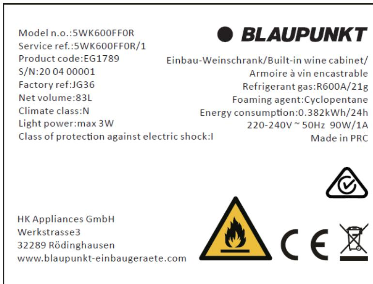
Das Typenschild befindet sich im Geräteinneren bzw. an der Geräterückseite (modellabhängig). Es enthält alle gerätespezifischen Angaben.
