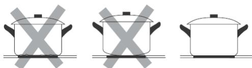
Sincerarsi che il fondo della pentola sia liscio e piano in modo da posarsi uniformemente sul piano in vetro, e che sia della stessa misura della zona di cottura. Collocare la pentola sempre al centro della zona di cottura.
