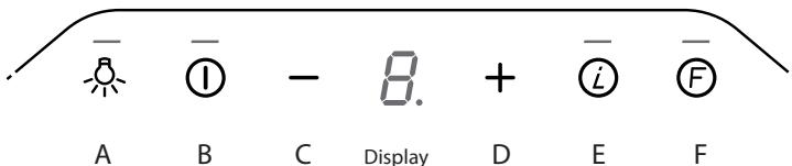
Ovaj uređaj omogućuje izbor načina rada (usis ili filtriranje), ovisno o načinu instaliranja. Prilikom prvog uključivanja, na zaslonu se prikazuje, u trajanju od jednog minuta, aktivran način rada.
