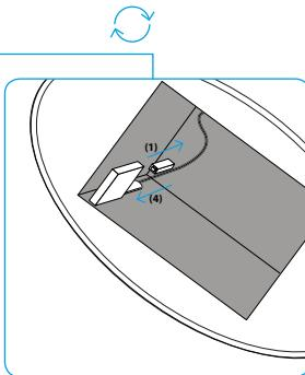
Slika 3 Enostavna namestitev sprejemnika. Sprejemnik lahko preprosto namestite brez dodatnih orodij. Odstranite okvir z vrhnjega dela nape in priključite sprejemnik. Odstranite napravo.
