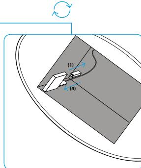
**Slika 3 Jednostavna ugradnja prijemnika** Prijemnik se može lako ugraditi bez dodatnih alata: Izvadite pokrovni okvir s **gornje strane** nape i pričvrstite prijemnik (1) **unutar** nape uklonite držać i priključite prijemnik (4).
