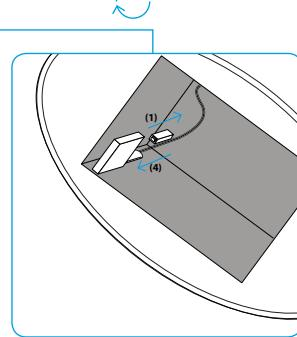
**Abb. 3 Einfache Montage des Receivers** Der Receiver lässt sich ohne zusätzliches Werkzeug einfach montieren: Abdeckrahmen an der **Oberseite** der Haube abnehmen und Receiver anbringen, Stick (1) **im Inneren** der Haube entfernen und den Receiver (4) einstecken.
