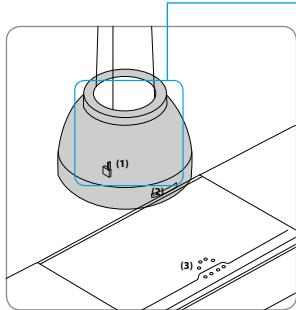
**Abb. 1 Inseesse in Standardausführung mit Stick (1) im Inneren der Haube und Bedienfeld (2) Die Steuerung der Haube erfolgt über den Masterswitch am Kochfeld (3) oder das Bedienfeld der Haube. Die Farbtemperatur beträgt 4.000 K.**
