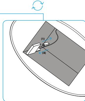
**Fig. 3 Installation facile du récepteur.** Le récepteur peut être facilement installé sans outils supplémentaires : Retirez le cadre du **haut de la hotte** et fixez le récepteur, (1) **retirez le stick** à l'intérieur de la hotte et branchez le récepteur (4).
