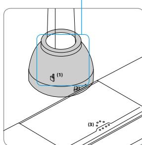
**Figure 1 Hotte de plan de cuisson en version standard avec stick (1) à l'intérieur de la hotte et tableau de commande (2).** La hotte est commandée par l'interrupteur général de la table de cuisson (3) ou du tableau de commande de la hotte. La température chromatique est de 4 000 K.
