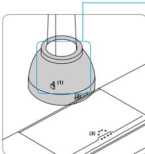
**Figur 1 Frihängande fläkt i standardversion med stift (1) inuti kåpan och kontrollpanelen (2)**
