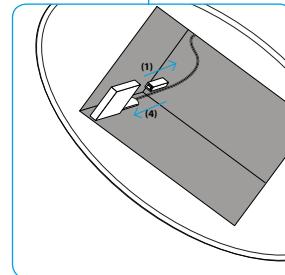
**Fig. 3 Installazione semplificata del ricevitore** Il ricevitore può essere installato facilmente senza strumenti aggiuntivi: Rimuovere il telaio di copertura dalla parte superiore della cappa e collegare il ricevitore, rimuovere il dispositivo (1) **all'interno** della cappa e inserire il ricevitore (4).
