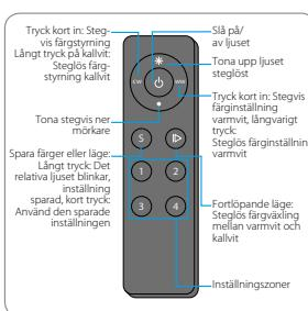
**Fig. 5 Fjärrkontrollens funktioner**
