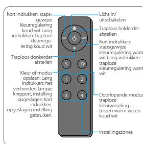
**Afb. 4 Ontvanger (4) en optionele Afstandsbediening (5) koppelen**
