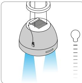
**Fig. 2 El control opcional por mando a distancia de las funciones de iluminación adicionales se puede montar fácilmente.** La instalación de un receptor (número de pedido BLZ 501) y el acoplamiento con el mando a distancia (número de pedido BLZ 502) permiten controlar la temperatura del color y la luminosidad de la campana.
