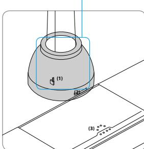
**Figura 1 Insolita nella versione standard con chiave (1) all'interno della cappa e del pannello di controllo (2)** La gestione della cappa è comandata tramite l'interruttore generale sul piano di cottura (3) o sul pannello di controllo della cappa. La temperatura del colore è 4.000 K.
