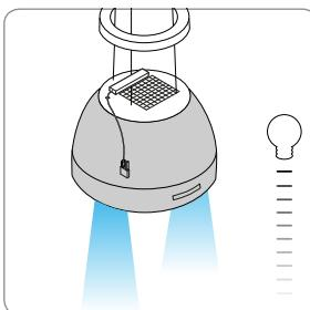
**Slika 2 Izborni upravljanje dodatnim rasvjetnim funkcijama putem daljinskog upravljača lako se može ugraditi.** Instalacija prijemnika (broj narudžbe BLZ 501) i spajanje s daljinskim upravljačem (broj narudžbe BLZ 502) omogućuju kontrolu temperature boje i osvjetljenje nape.
