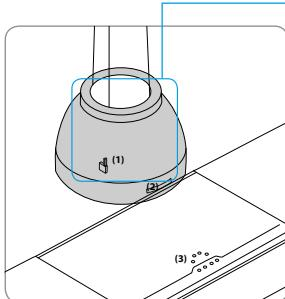
**Slika 1 Napa u standardnoj izvedbi s držačem (1) unutar nape i upravljačkom pločom (2)** Napomene se upravlja preko glavne sklopke na ploči za kuhanje (3) ili na upravljačkom polju nape. Temperatura boje je 4000 K.
