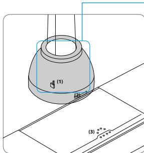
**Fig. 1 Campana de isla en versión estándar con Stick (1) y panel de control (2) dentro de la campana.** El control de la campana se lleva a cabo mediante el interruptor principal en la placa de cocción (3) o en el panel de control de la campana. La temperatura de color alcanza 4.000 K.
