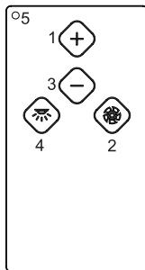
**1: + motor****2: On/Off motor****3: - motor****4: On/Off light****5: Led**
