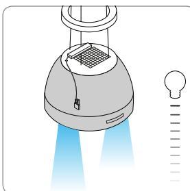
**Sl. 2 Opciono upravljanje dodatnim funkcijama osvetljenja preko daljinskog upravljača može se lako montirati.** Ugradnja prijemnik u aspirator i povezivanje sa daljinskim upravljačem (kataloški broj BLZ 502) omogućavaju kontrolu temperature boje i osvetljenosti aspiratora.
