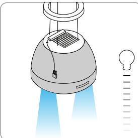
**Fig. 2 Il controllo opzionale di ulteriori funzioni di illuminazione tramite telecomando può essere installato in modo semplice:** l'installazione di un ricevitore (numero d'ordine BLZ 501) e l'accoppiamento con il telecomando (numero ordine BLZ 502) consentono di controllare la temperatura del colore e la luminosità della cappa.
