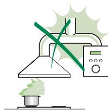
Spojite aspirator na odvod dima putem cijevi minimalnog promjera od 120 mm. Cijev za prolazak dima mora biti što je kraća moguća.
