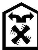
Usisani zrak čisti se prolaskom kroz filter za masnoću i filter s aktivnim ugljenom te se ponovno dovodi u kuhinju.
