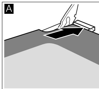
2. Postavite pokrov gore na vratima pećnice i pritisnite ga. Pazite da se urezi na stranicama pravilno uglave.
