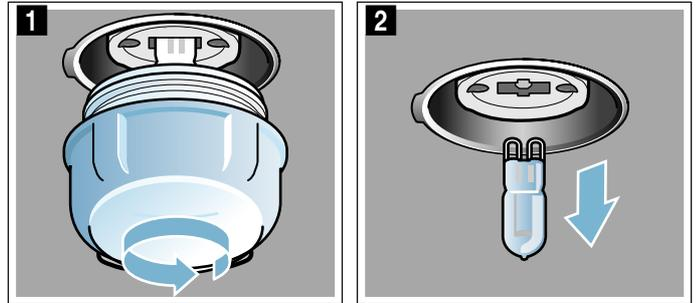
4. Skruva på lampglaset igen. Lampglaset kan ha en tätningring beroende på enhetstyp. Sätt på tätningringen innan du skruvar i.
