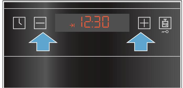
Nakon nekoliko sekundi pećnica preuzima postavke. Na kontrolnoj ploči prikazuje se vrijeme kraja. Kada pećnica radi, prikazuje se namještena temperatura.
