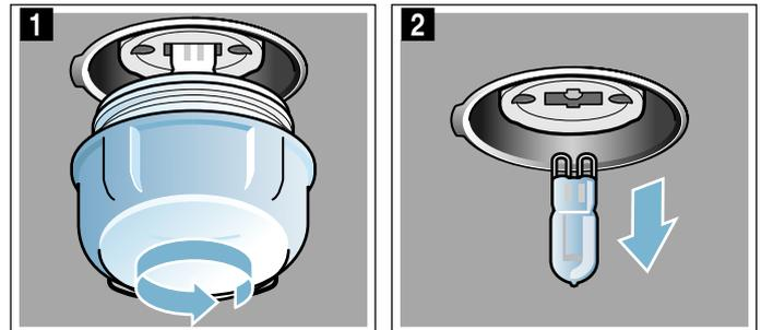
4. Ponovno pričvrstite stakleni poklopac. Ovisno o tipu uređaja stakleni poklopac je opremljen brtvenim prstenom. Prije pričvršćivanja ponovno stavite brtveni prsten.
