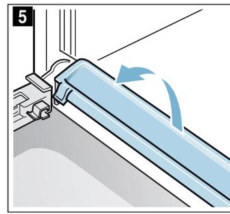
Rengör luckglasen med fönsterputs och mjuk trasa. Torka av kondensatlisten med trasa och varmt vatten och diskmedel.
