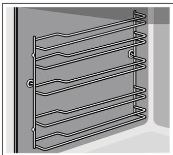
1. Lyft ugnstegarna lite fram till **a** och ta ur **b** (bild **1**).
