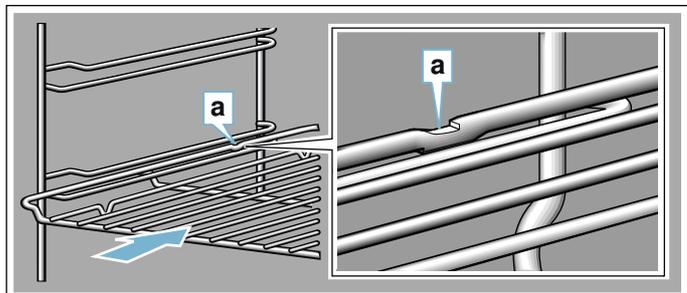
Du måste se till så att det bakre snäppfästet **a** pekar nedåt när du sätter i plåtarna. Den sluttande kanten på tillbehöret **b** ska vara mot luckan.
