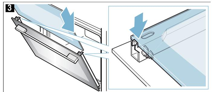
5. Sätt tillbaka skyddet och tryck till så att det snäpper fast (bild 4).
